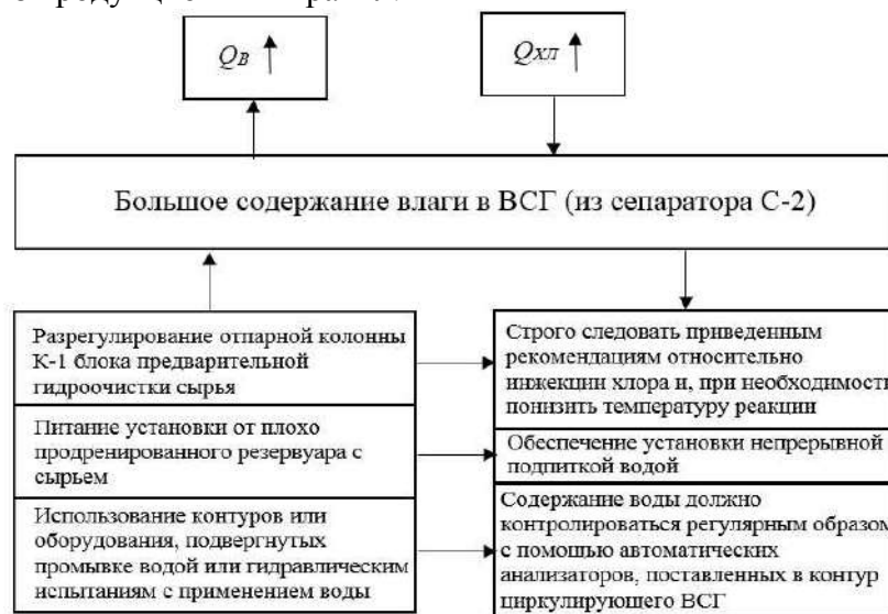
Рис. Диаграмма взаимосвязей для признака неисправности «Большое содержание влаги в ВСГ»: Q_B – содержание воды в ВСГ, ppm по объему; Q_{ХЛ} – количество хлора, которое необходимо вводить в сырье, ppm по массе/кг сырью; стрелки рядом с обозначением параметра показывают, что увеличение данного параметра влияет на данную неисправность или зависит от нее
