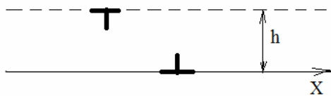
Рис.1. Схема взаимодействия двух краевых дислокаций.
